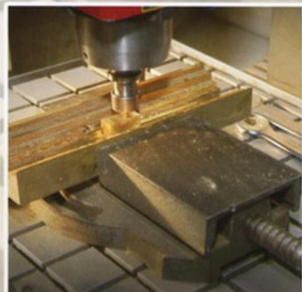
MGS, dispone di un reparto con attrezzature di elevata automazione in grado di effettuare produzioni in serie 24 ore su 24. Il "sistema", infatti, è costituito da una morsa rotante con caricatore automatico che permette l'incisione sui due lati.
