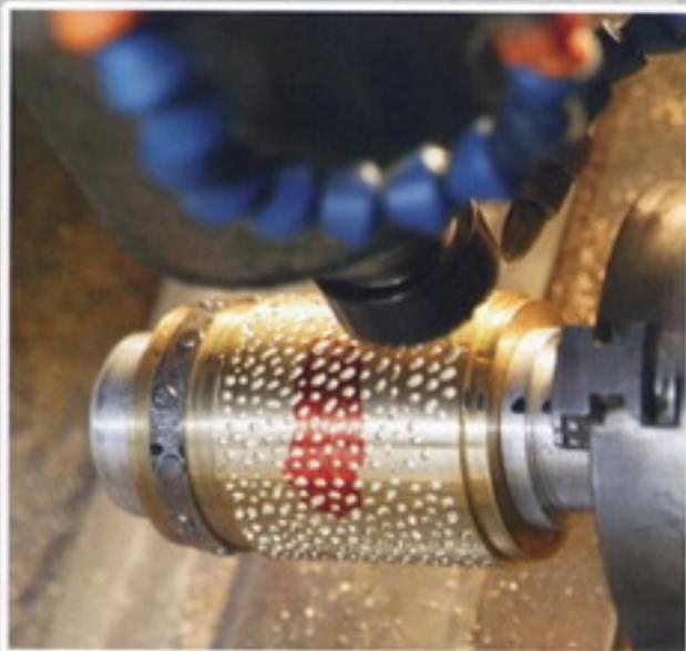
**E**sempio di stampo cilindrico per la marcatura, impressione e taglio di materiali. Le lavorazioni si possono ottenere sia con il sistema manuale che con quello a controllo numerico.
