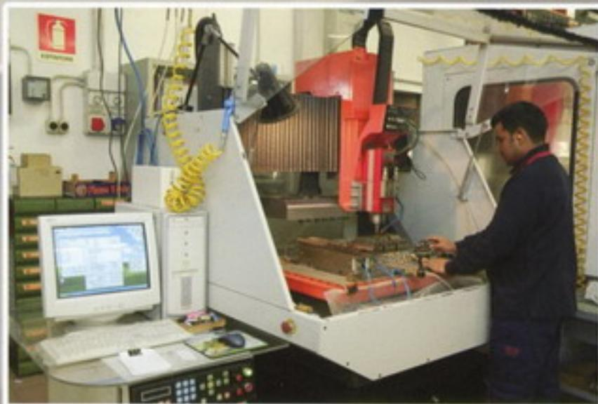
Macchine per la lavorazione di stampi in ottone e acciaio in rilievo e bassorilievo per cinture e per "marcature" in continuo.
